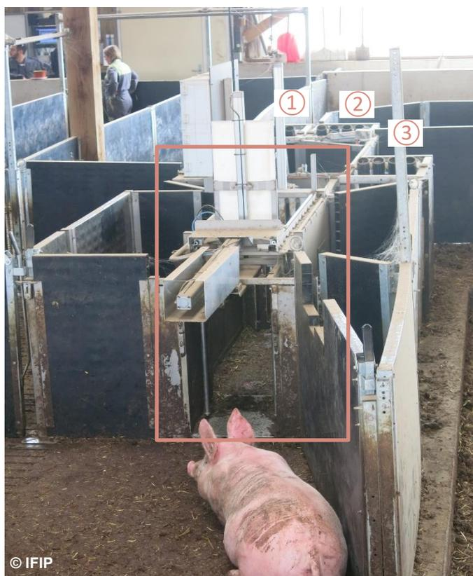
Ajouter une 3<sup>ème</sup> sortie sur la station de tri (en rose) pour trier plus facilement des porcs
