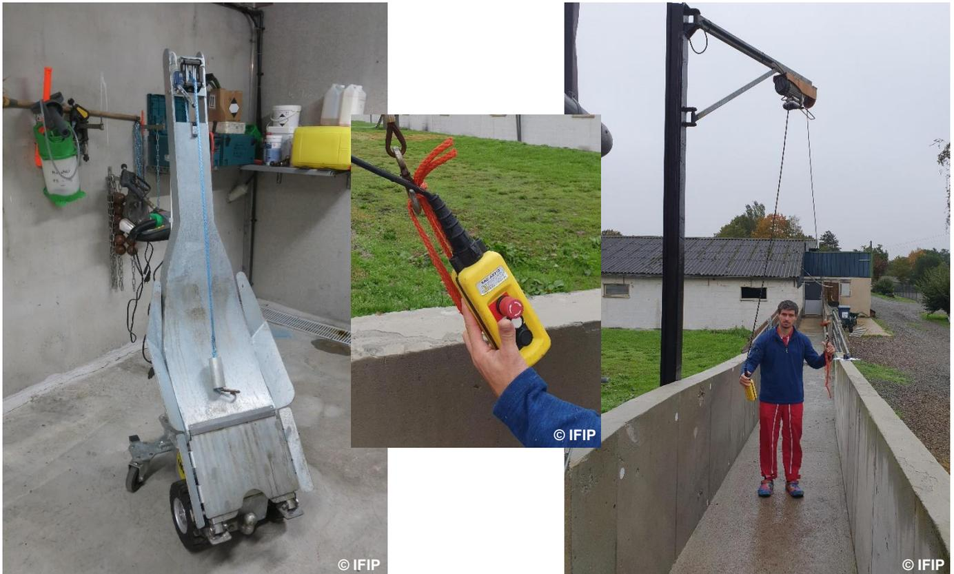
Utiliser un chariot pour sortir les cadavres à l'extérieur des bâtiments puis un treuil pour les déposer, par-dessus un muret, en dehors de la zone d'élevage
