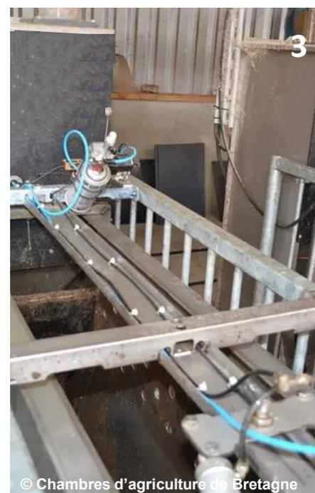
Choisir son dispositif : peser et trier les animaux grâce à une station de tri (1. pesée par caméra 2D équipée de laser, 2. pesons mécanique) ou 3. peser et marquer les animaux avec un DAC
