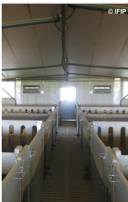
Installer les volets d'entrée d'air au-dessus de la zone caillebotis pour générer un inconfort (retombée d'air frais et vitesse d'air) qui orientera la zone de déjection
