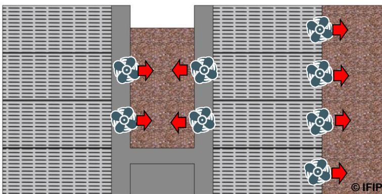
Le biofiltre peut être positionné entre deux bâtiments (à gauche) ou le long d'un bâtiment (à droite)
