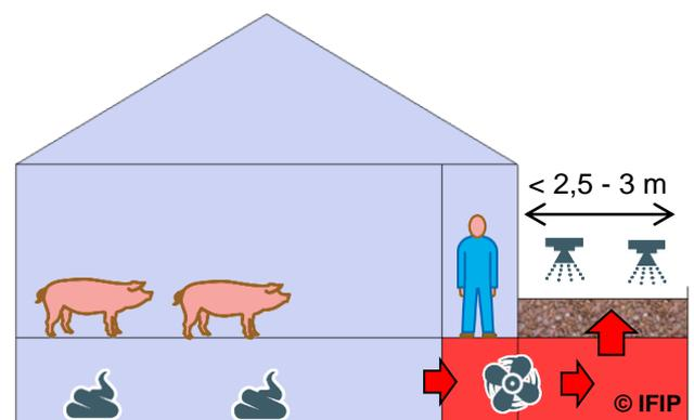
En sortant de la gaine centralisée du bâtiment, l'air est poussé à travers un substrat organique humide.
