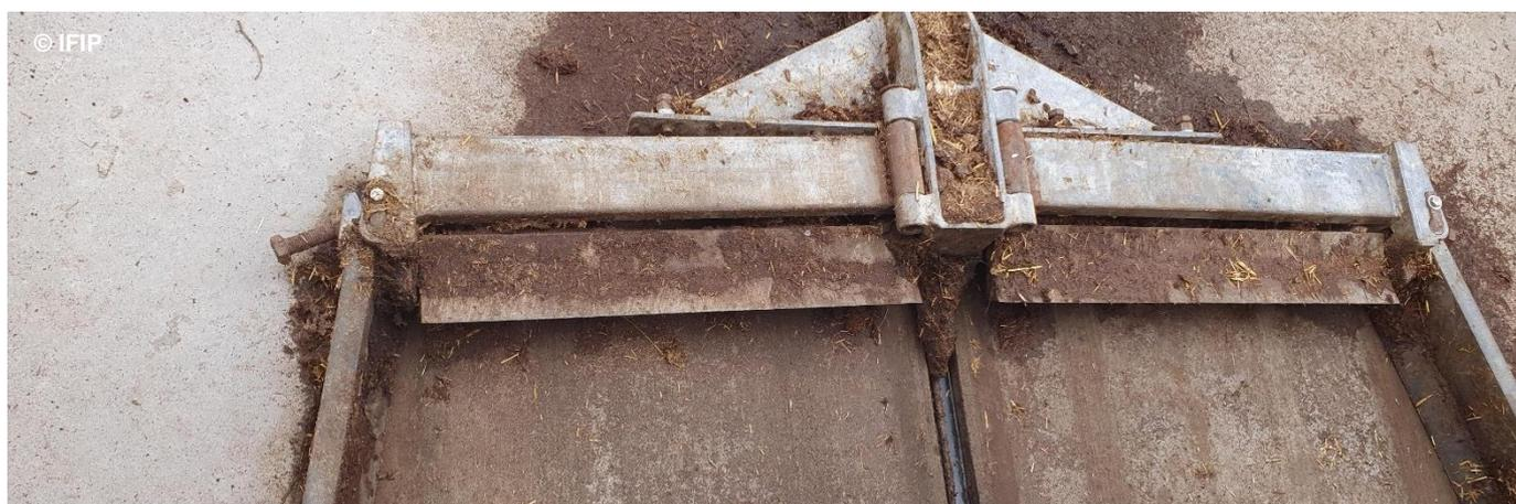
Raclar sous caillebotis pour disposer de déjections fraîches au potentiel méthanogène élevé et éviter les émissions de gaz à effet de serre (GES) en bâtiment
